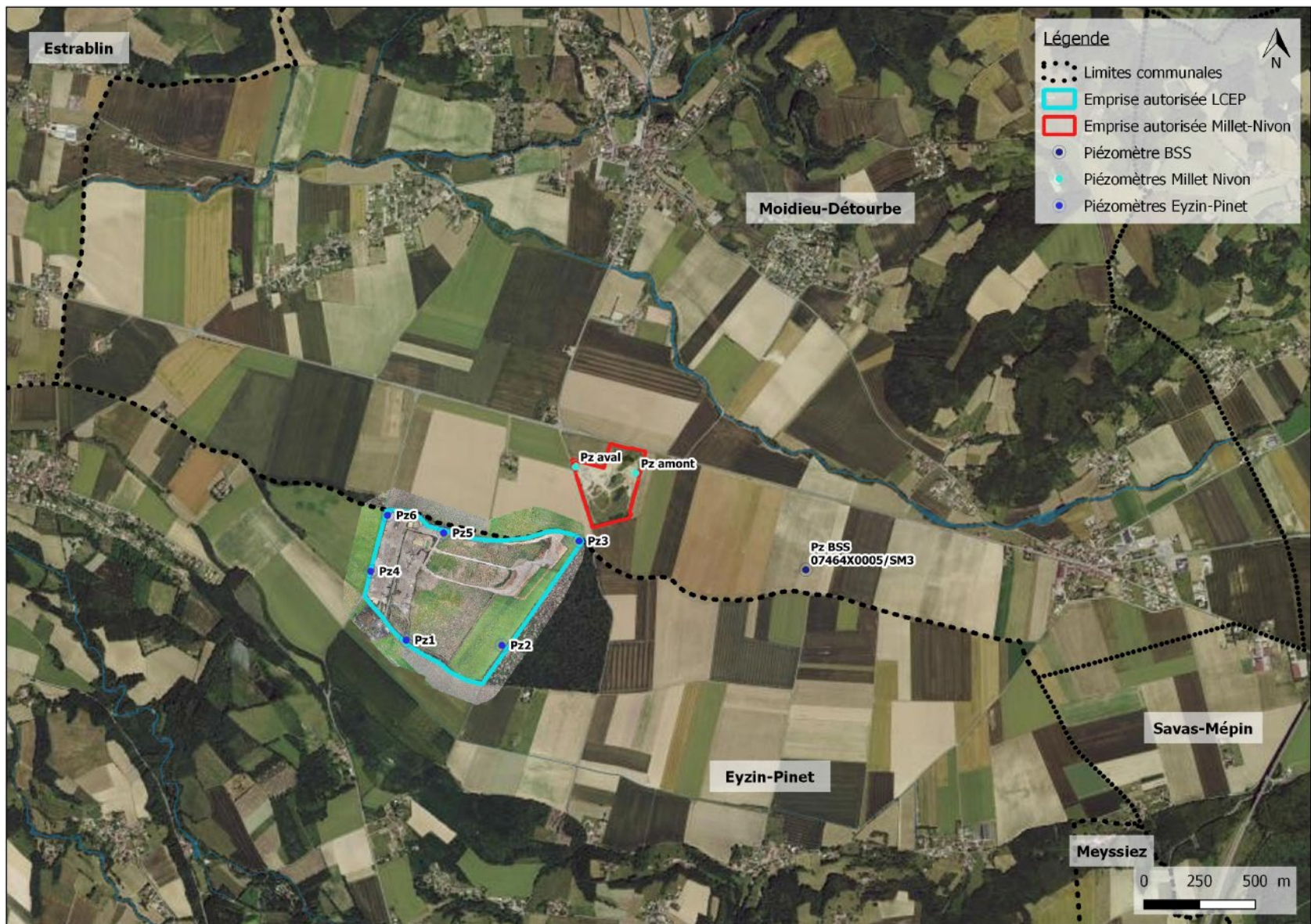
Figure 49 : Localisation des points de suivi piézométrique et de qualité des eaux souterraine au niveau des carrières d'Eyzin-Pinet et de Moidieu-détourbe
