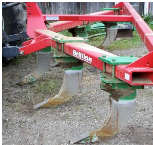
Illustration n° 2 : Exemple de matériels de sous-solage attelés montrant des dents incurvées (photo de gauche) ou obliques (photo de droite).
